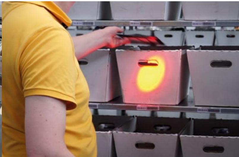
Durch den intelligenten Einsatz bewährter Technologie haben wir eine innovative Lösung für lichtgeführte Pick- und Put-Prozesse entwickelt. Anders als in klassischen Systemen ist nicht das Regalfach mit der Lichttechnik versehen, sondern der Lichtpunkt wird auf das gewünschte Objekt projiziert.
